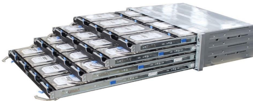
图 3-5 3U 硬盘模块结构图
